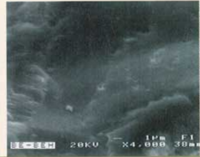
Abb. 8: Elektronenstrahlmikroskopische Aufnahmen von Betonboden-Oberflächen: links unbehandelt, Mitte und rechts behandelt (links und Mitte 1.500-fach vergrößert, rechts 4.000-fach vergrößert).
