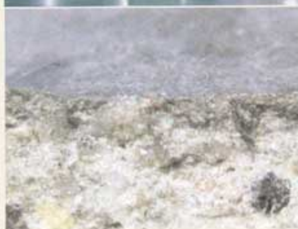
Abb. 6 und 7: Mit modifiziertem Natriumsilikat veredelter Beton. Die Oberfläche ist geschlossen, verfestigt und staubfrei.
